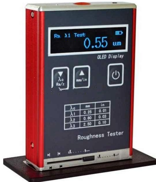
**Ra100 粗糙度仪:**拉丝铝外观,防磁抗摔结实耐用,高亮彩屏显示,测量参数 Ra, Rz 。采用优化的电路设计及传感器结构设计,将电箱、驱动器及显示部分合为一体,使其达到高度集成化;任意选择 Ra、Rz 测量参数;不仅可测量外圆、平面、锥面,还可测长宽大于 80×30mm 的沟槽。
