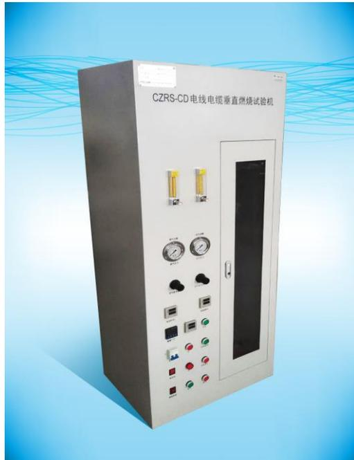
**产品介绍：**电线电缆垂直燃烧试验机符合 GB18380.11-2008《电缆在火焰条件下的燃烧试验第一部分：单根绝缘或电缆垂直燃烧试验方法》，等效采用 IEC60332-1。适用于测定单根塑料线、控制、交联、电梯、船用、矿用电缆等不延燃性能。并可做高自熄性低烟无卤阻燃聚烯烃绝缘料和 105℃低烟无卤阻燃烯烃辐照绝缘料的垂直燃烧试验。
